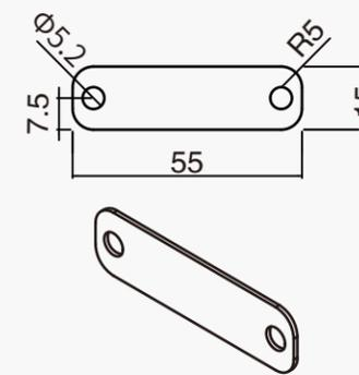
用于木质与塑料的吊装板并可修正吊装板的不水平
